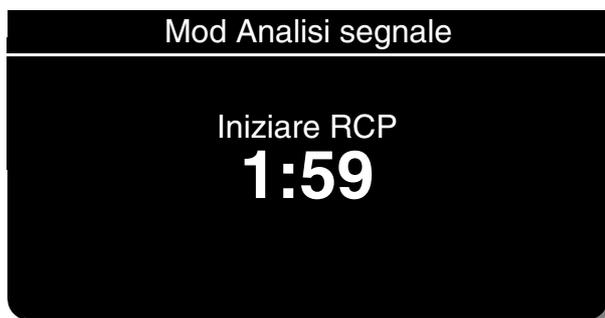
Dopo l'erogazione di uno shock, il messaggio INIZIARE RCP viene visualizzato ed enunciato. Per la durata specificata nell'opzione di impostazione TEMPO RCP 1 rimane visualizzato un conto alla rovescia (nel formato minuti:secondi).
