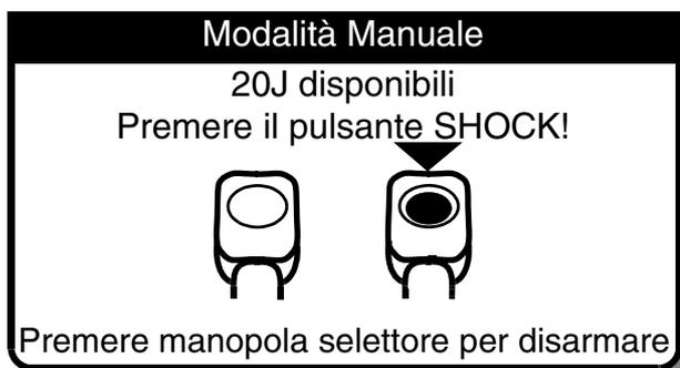
Premere il pulsante shock sul manico interno per scaricare l'energia. Il pulsante SHOCK sul pannello frontale è inattivo.
