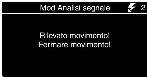
Se il DAE rileva movimento durante l'analisi ECG, il messaggio RILEVATO MOVIMENTO, FERMARE MOVIMENTO viene visualizzato ed enunciato seguito da un segnale di avviso. L'analisi viene interrotta fino alla cessazione del movimento o fino a un massimo di 10 secondi. Dopo la cessazione del movimento oppure una volta trascorsi i 10 secondi, l'analisi riprende e viene completata anche in presenza di movimento. Fare riferimento alla Tabella 4-1, page 4-12 per possibili cause e soluzioni suggerite.
