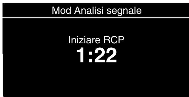
Una volta completata l'analisi, verrà visualizzato ed enunciato il messaggio **INIZIARE RCP**. Un conto alla rovescia (formato minuti:secondi) continua per la durata specificata nell'opzione di impostazione del tempo di RCP **PRESHOCK** (ad esempio per 15 secondi).
