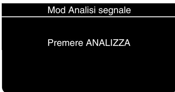
Al termine del conto alla rovescia della RCP verrà visualizzato ed enunciato il messaggio PREMERE ANALIZZA. Il messaggio rimane visualizzato sullo schermo e viene ripetuto ogni 20 secondi, fino a che non si preme il pulsante ANALIZZA.
