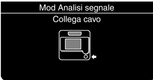
Se il cavo di defibrillazione non è collegato al defibrillatore, il messaggio COLLEGA CAVO viene visualizzato fino al collegamento del cavo.
