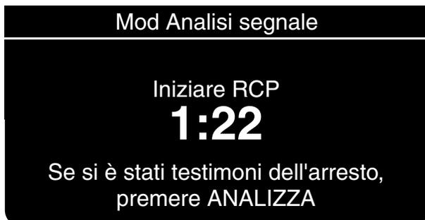
Dopo 3 secondi, per la durata specificata nel periodo di RCP iniziale, rimane visualizzato un conto alla rovescia. Inoltre verrà visualizzato ed enunciato il messaggio SE SI È STATI TESTIMONI DELL'ARRESTO, PREMERE ANALIZZA. In questo modo sarà possibile interrompere in anticipo la RCP iniziale e procedere con l'analisi.
