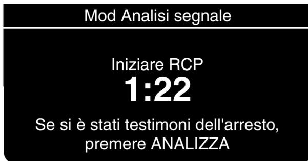
Se il DAE rileva un ritmo da trattare, verrà visualizzato ed enunciato il messaggio INIZIARE RCP seguito dal messaggio SE SI È STATI TESTIMONI DELL'ARRESTO, PREMERE ANALIZZA. In questo modo sarà possibile interrompere in anticipo la RCP iniziale e procedere con l'erogazione dello shock.
