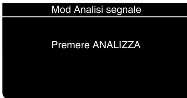
Il messaggio sullo schermo e il messaggio vocale PREMERE ANALIZZA vengono emessi quando il paziente è stato collegato correttamente al DAE. Il messaggio PREMERE ANALIZZA rimarrà sullo schermo e il LED ANALIZZA continuerà a lampeggiare fino a che non verrà premuto il pulsante ANALIZZA.
